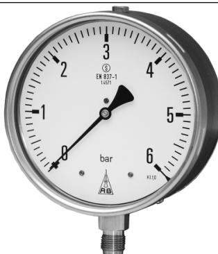
стенкой; при образовании давления в корпусе задняя стенка полностью (по всему периметру) откладывается назад. Приборы с диапазоном измерений 0,6 до 0/1000 бар проверены в соответствии с EN 837-1 S3 и маркированы значком (S) EN 837-1.
