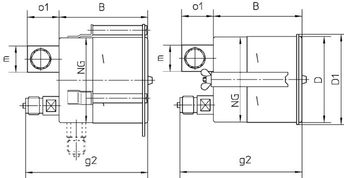
приваренные к корпусу крепежные накладки и съемный передний фланец (FrL, гFrL)
