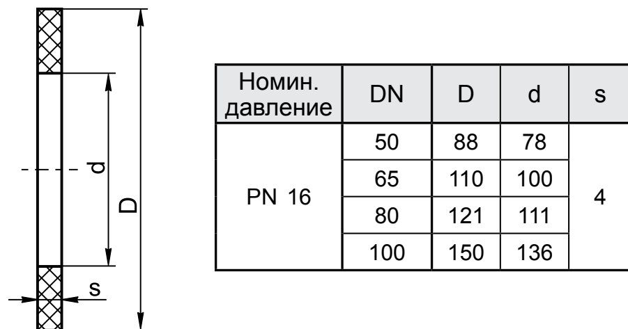
Рис. 1-2. Прокладка из резины листовой марки МБС (для PN 16)
