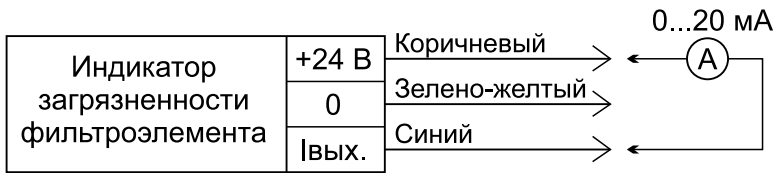
Рис. 22-31. Схема подключения индикатора, работающего от сети
