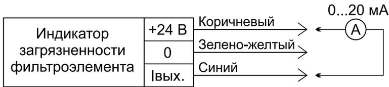
Рис. 22-31. Схема подключения индикатора, работающего от сети
