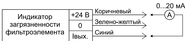
Рис. 10-40. Схема подключения индикатора, работающего от сети
