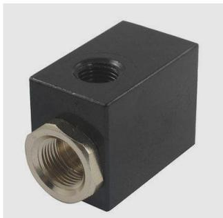
Клапаны быстрого выхлопа предназначены для ускорения движения поршня пневмоцилиндра. Ускорение достигается благодаря сбрасыванию воздуха в атмосферу через клапан быстрого выхлопа, установленный непосредственно рядом с цилиндром, а не выхлопные отверстия распределителя.
