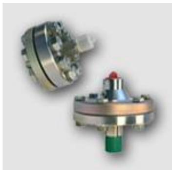
Измеряемое давление передается через мембрану и разделительную жидкость на чувствительный элемент измерительного устройства, соединенного с разделителем.
