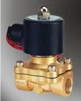
Серия клапанов с прямым управлением, приводится в действие непосредственно электромагнитом (подходит для использования и при минимальном давлении рабочего потока, и при достаточно высоком давлении).
