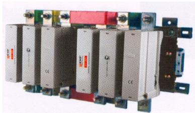
Контактыры электромагнитные серии КТЭ предназначены для использования в схемах управления для пуска и остановки трехфазных асинхронных электродвигателей с короткозамкнутым ротором в электрических сетях с напряжением до 660В переменного тока.
