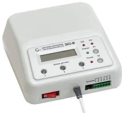
**Предназначена** для непрерывного автоматического контроля дозрывоопасных концентраций природного газа (метан, CH<sub>4</sub>) и предельно допустимых концентраций оксида углерода (угарный газ, CO) в воздухе помещений, контроля пожара и для управления исполнительными устройствами.
