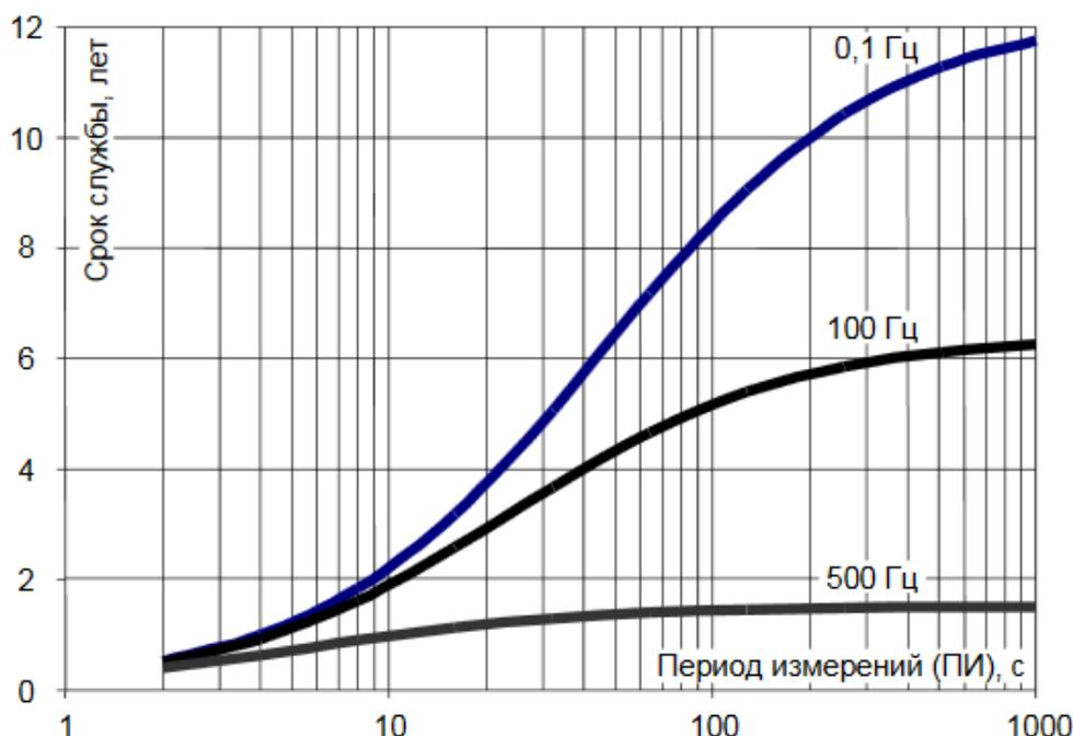
Рисунок — Зависимость расчетного ресурса батареи от периода измерений (ПИ) и частоты входного сигнала, соответствующего расходу, (при температуре 5–25 °С, скважности импульсов не менее 10 и времени работы табло не более пяти часов в месяц)
