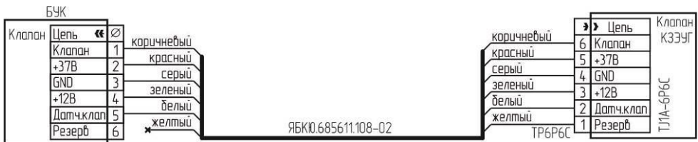
Рисунок 4 – Схема подключения клапана КЗЭУГ с разъемом TJ1A-6P6C.
