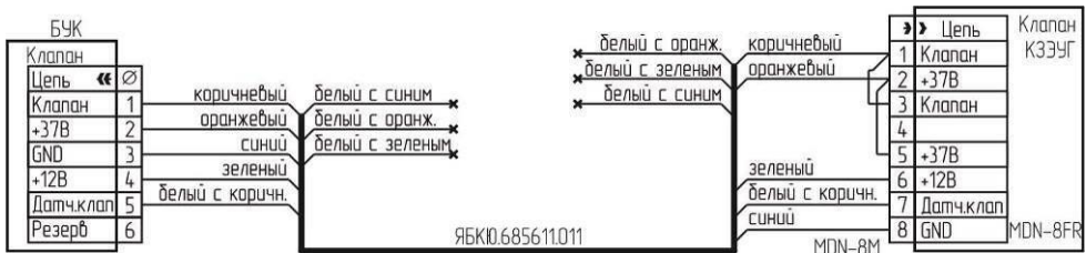
Рисунок 6 – Схема подключения клапана КЗЭУГ с разъемом MDN-8FR.
