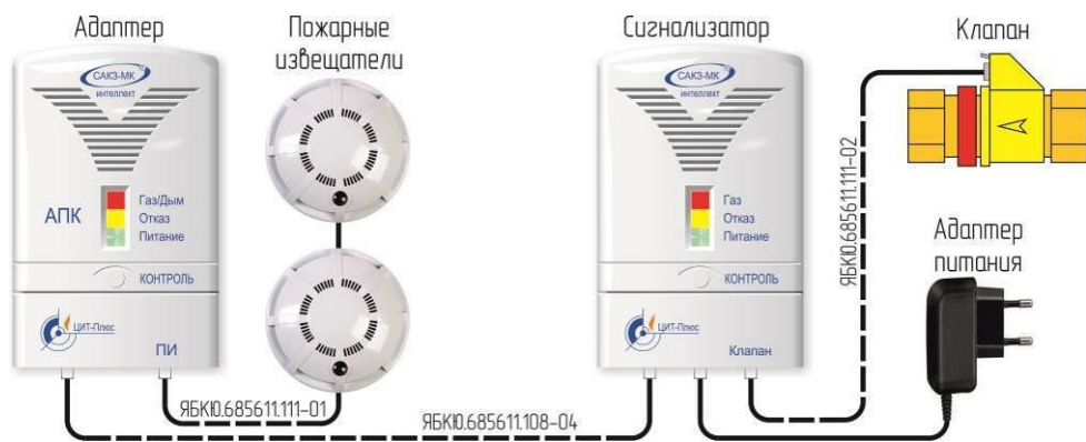
Рисунок Б.2 – Типовая схема подключения пожарных извещателей
