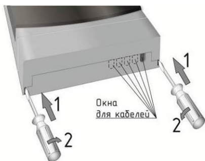
Рисунок 2 – Снятие крышки клеммного отсека
