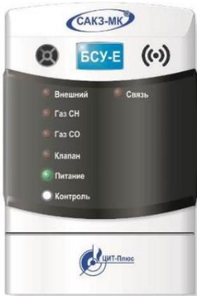
Служит для приема, индикации и запоминания сигналов от сигнализаторов загазованности, датчика положения газового клапана, а также формирования выходного сигнала управления исполнительным устройством и импульсным электромагнитным клапаном газоснабжения с ручным взводом при аварийной ситуации.
