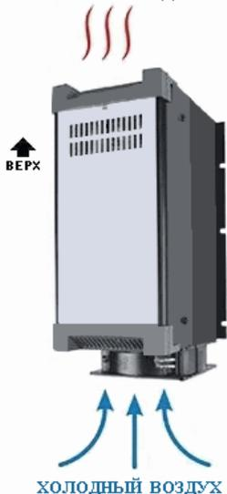
Работа тиристорного регулятора мощности сопровождается выделением тепла. Для обеспечения нормального охлаждения регулятора, его необходимо устанавливать в вертикальное положение, для обеспечения естественной циркуляции воздуха вдоль радиатора охлаждения.
