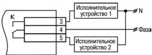
Схема подключения нагрузки к ВУ типа Р
